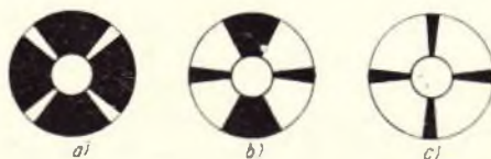
Abb. 14. Die Anzeige der Doppelabstimmröhre EM 11: a) kein Sender, b) mittlerer Sender, c) starker Ortsender
