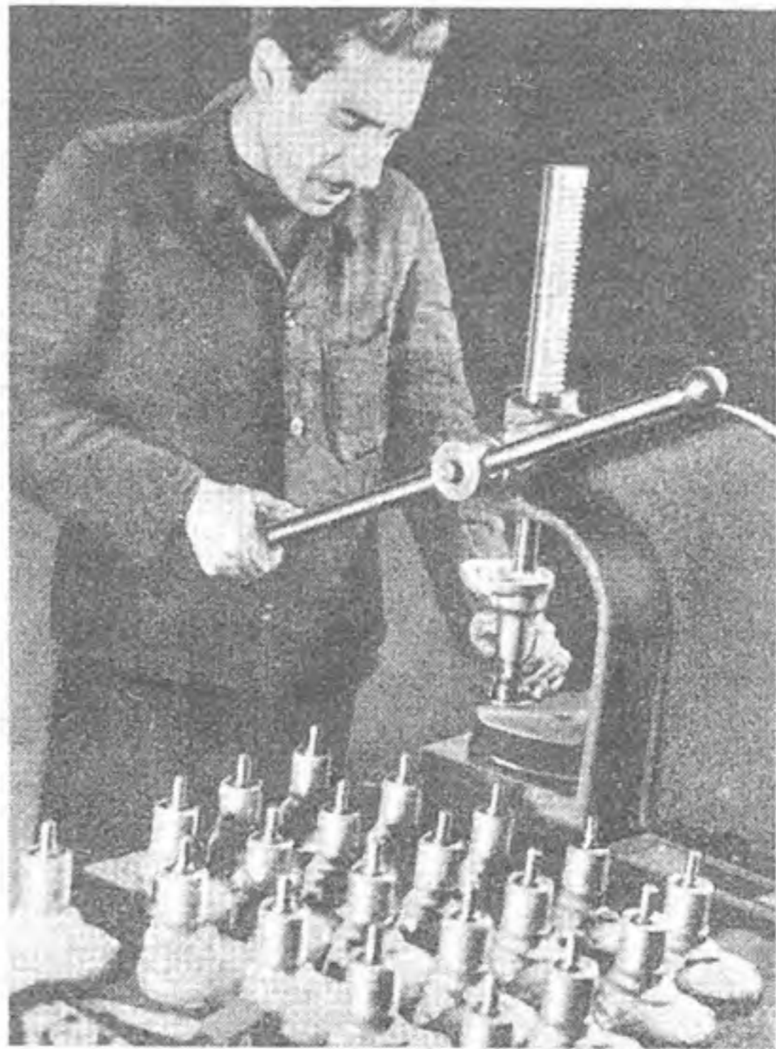
Aufdrücken der Kugellager auf die Wellen von Elektrowerkzeugen
