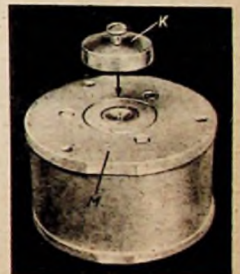
Der Magnet (M) mit dem Schwingspulen-spalt, darüber der Aluminium-Kühlring (K)
