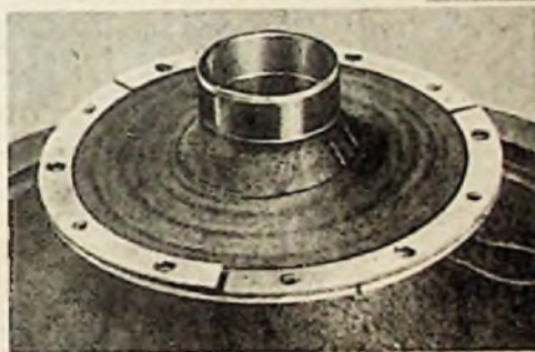
Membran mit Flächenzentrierung und dem innen mit Aluminiumfolie beklebten Schwingspulenkörper
