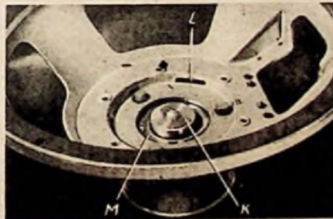
Membran mit Flächenzentrierung und dem innen mit Aluminiumfolie beklebten Schwingspulenkörper
