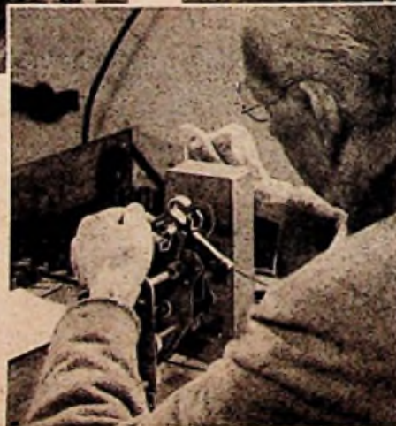
Herstellen der Kurzwellenspulen aus 0,9 mm starkem Lackdraht auf einer selbstkonstruierten Wickelmaschine. Links: Tempern im Härteofen bei etwa 1500°C verleiht den an drei Stellen mit Spezialkleber getränkten KW-Spulen eine überraschende Stabilität. Rechts: der fertige Spulensatz wird zu einer Schlußprüfung einer Gütemessung im Betriebszustand unterzogen. Gleichzeitig werden die Induktionswerte abgeglich
