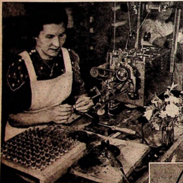
An der Arbeitshablone werden nach dem Wickeln die Drahtenden der Kreuzwickelspule gekürzt
