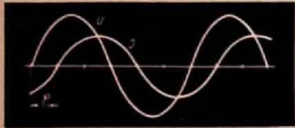
Abb. 1. Oszillogramm einer Wechselspannung und eines um 60^\circ nachteilenden Wechselstromes
