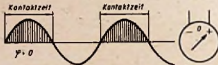
Abb. 4. Höchstwert des Instrumentenausschlages bei Übereinstimmung der Kontaktzeit mit Dauer und Lage einer Halbwelle
