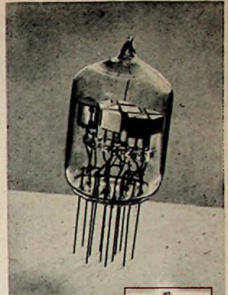
Abb. 1. Ansicht des Vervielfachers Vp A 11 tp 69 von Dr. Georg Maurer. Etwa 8/10 nat. Größe. Das feindrähtige Gitter stellt die Fotokatode dar
