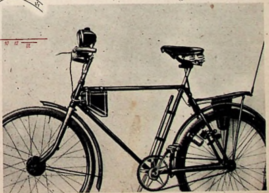
1. Typo: 4 Pole Rechts: 2. Typo: 8 Pole Typenschild: 6,9 V 2,1 VA Typenschild: 10 V 4,5 VA
