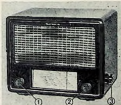
1. Lautstärkerogler, kombiniert mit Netzschalter, 2. Abstimmung, 3. Wellenbereichschalter
