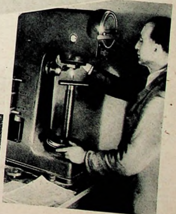
Zahnkranz-Kurbelwelle, Bohrer u. a. m. erhalten durch die HF-Induk- tionshärtung eine größere Festig- keit. Rechts: Härteprüfeinrichtung. Unten: Gefügebild eines ober- flächengehärteten Endmaßstabes
