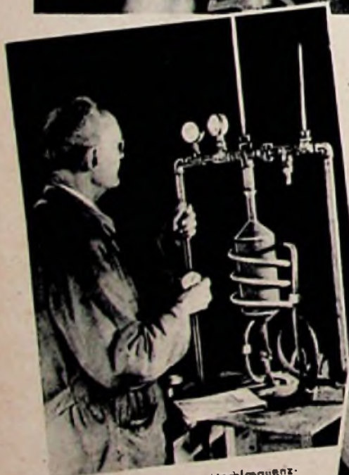
Meßwiderstand zur Hochfrequenz-Leistungsmessung: Rechts: Glühübertrager und Heizleiterschleifen für verschiedene Werkstücke. Die Heizleiterschleifen bestehen aus Röhren, in denen ständig Kühlwasser fließt
