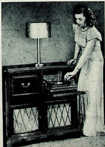
Die neue Langspielplatte in Betrieb. Der Plattenspieler macht 33 1/3 Umdrehungen, kann aber auch auf 78 Umdrehungen umgeschaltet werden. Er besitzt außerdem zwei Tonarme. Aufn. P.A.-Reuter
