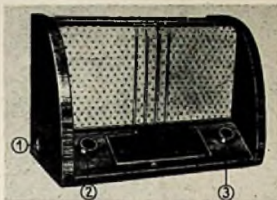
① Wellenbereichumschalter, ② Netzschalter und Lautstärkeregl. ③ Abstimmung
