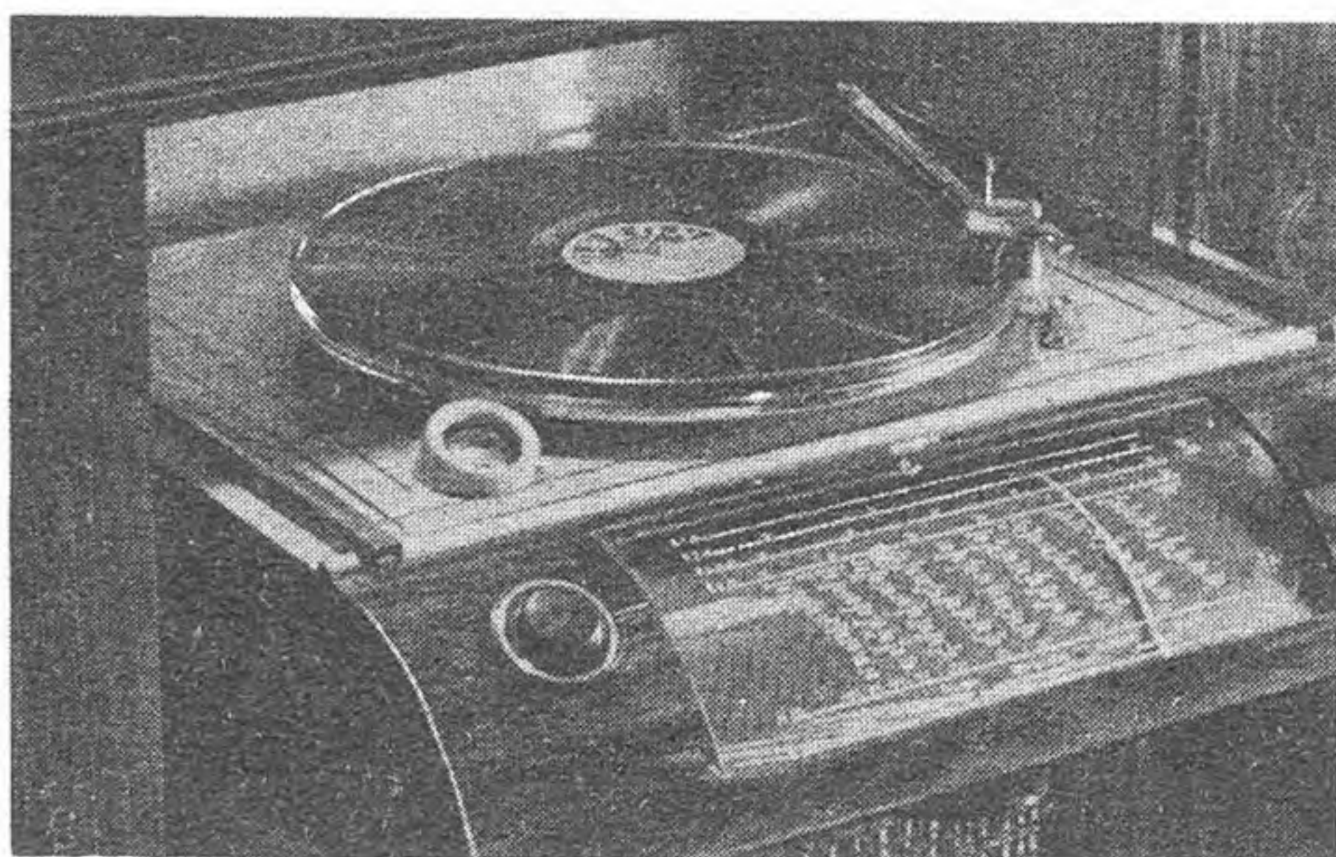
Rundskala und Bedienungsknöppe im herausziehbaren Schallplattentisch einer Musiktruhe von W. Jablonski / Lübbert & Peters
