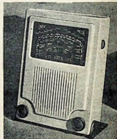
Neuartiger Kleinsuper von SAFAR in Form einer großen Fotografie für Wechselstromanschluß (Luxusausführung), bestückt mit 12 TE 8 — 12 NK 7 — 12 Q 7 — 35 L 6 — 35 Z 4
