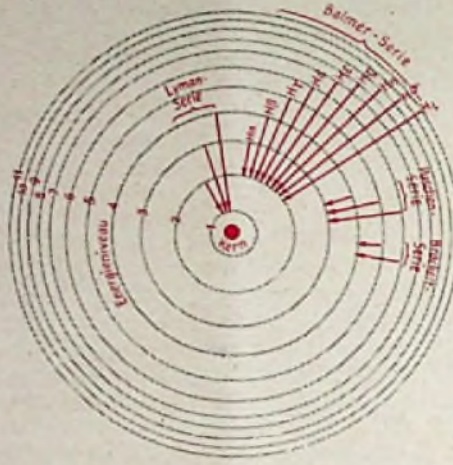
Abb. 2. Darstellung der beim Wasserstoffspektrum auf Grund des Linienspektrums möglichen Elektronensprünge. (Die Verteilung der Elektronenbahnen entspricht nicht den tatsächlichen Bahnradien, sondern ist der besseren Übersicht wegen ungefähr den Energiewerten der Bahnen angepaßt.)
