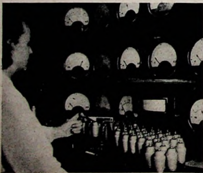
Abb. 11. Röhrenprüfung. Es müssen bei der Endkontrolle zahlreiche Meßinstrumente abgelesen werden. Trotzdem geht die Prüfung schnell vonstatten. Die Arbeiterin entnimmt die zu prüfende Röhre einem Vorheizgerät, um Zeit zu sparen
