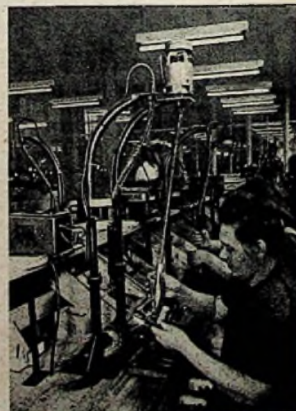
Abb. 4. Fertigung der „Filius-Umstellung“ mit Klein-Schweißgeräten im Werk Hannover
