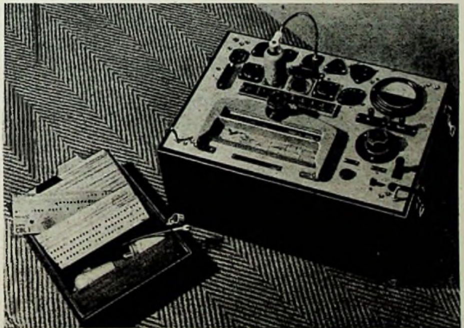
Siemens-Röhrenmeßgerät 9 Rel 3 K 311. Ein Lochkartenschalter vereinfacht die Bedienung durch selbsttätiges Einschalten aller Betriebsspannungen und Meßbereiche.
