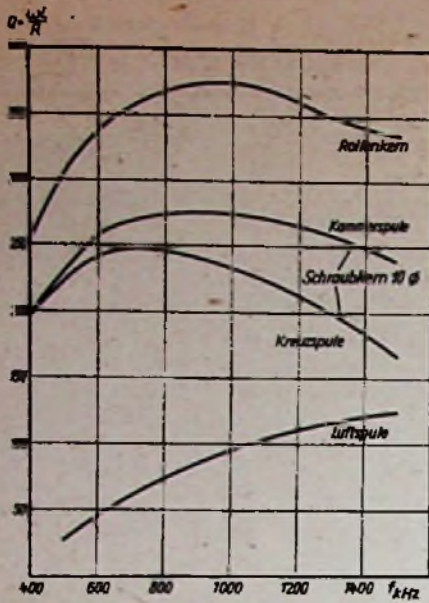
Spulengüte Q = F(f, \text{kHz}) . L = 0,2 \text{ mH} , d = 20 \times 0,05 \text{ LS} ohne Abschirmung
