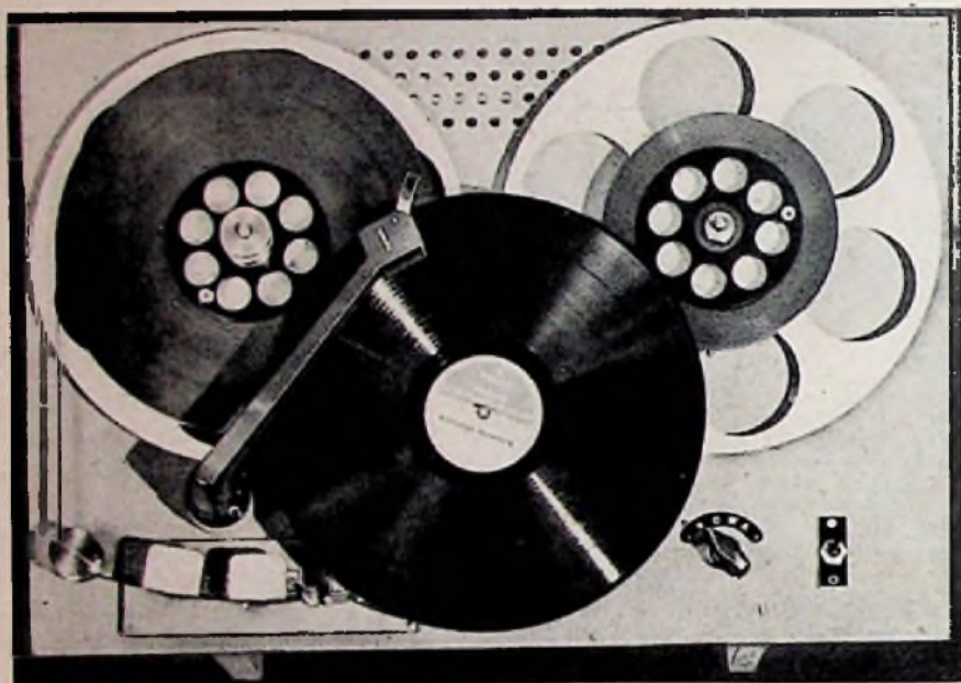
Durch Aufsetzen einer leichten Aluminiumscheibe auf die Tonrolle und Einstecken eines Tonabnehmers ist das Gerät auch als Plattenspieler verwendbar. Rechts: Schaltung des elektrischen Teiles des Tonbandgerätes mit Löschsender und Wiedergabeverstärker (Allstrom)
