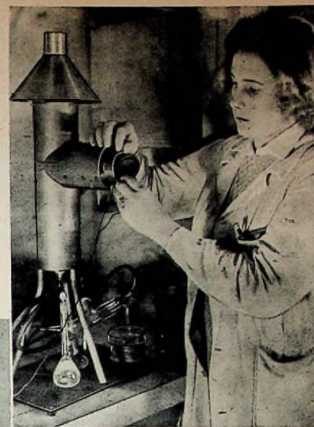
Prüfung des fotoelektrischen Flammenfotometers, das durch Flammenfärbung eine schnelle Untersuchung des Bodens auf seine Nährstoffe zur Ermittlung der richtigen Düngung erlaubt und damit Bedeutung für die Agrarkulturchemie besitzt
