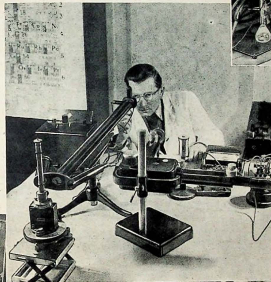
Im Labor werden die Sperrschicht-Fotozellen mit Monochromator und Spiegelgalvanometer auf ihre spektrale Empfindlichkeit geprüft
