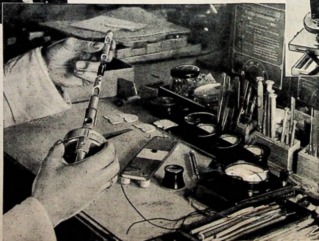
Wickeln der temperaturunabhängigen Manganinvorwiderstände für die verschiedenen Meßbereiche, eine Arbeit für gewissenhafte Fachkräfte
