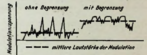
Abb. 6. Unbegrenzte und begrenzte Modulationsspannung
