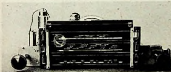
Abb. 3. Um bequem abgleichen zu können, ist die dreiteilige Flutlichtskala am Chassis befestigt
