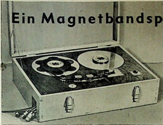
Abb. 1. Auf der Laufwerkplatte befindet sich rechts ein quadratisches Blech, an dem der Motorschalter und die Sicherung angebracht ist. Links vor dem Hörfopf eine kreisförmige Abdeckung für die Warnlampe
