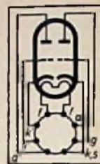
Sockelschaltung Anschlüsse von unten gesehen
