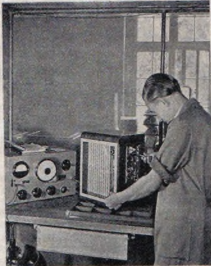
Endkontrolle der Geräte im abgeschirmten Käfig
