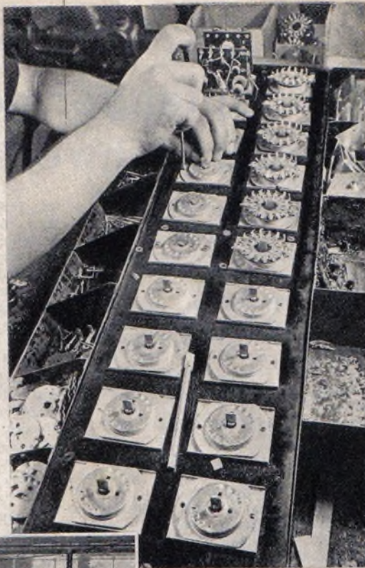
Zusammenbau der Bereichschalter (links) und Kontrolle der Lautsprechermagnete auf Leistung und Sauberkeit (rechts)
