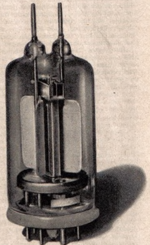
Der Allglas-Aufbau der QQ 06/40 (Philips) mit Sinterglas-Bodenplatte sichert gute Stabilität und niedrige Elektrodenkapazität
