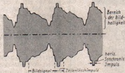
Abb. 2 Negativ modulierte Trägerwelle eines Fernsehsenders; hohe Amplituden ergeben dunkle, niedrige Amplituden helle Bildpunkte. Bei negativer Modulation ist es umgekehrt; die Synchronisationsimpulse liegen dann nach innen, der Mittelachse des Schwingungszuges zugekehrt
