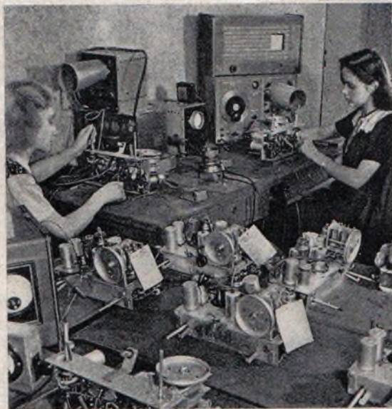
Prüfstand mit optischen Meßgeräten für die ZF-Einstellung und Bandfilter. Rechts: Neuzeitliche Druckmaschine zum Beschriften der Geräte rückwände, die wie die Gehäuse und Einzelteile ebenfalls im Werk hergestellt werden
