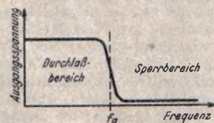
Abb. 12. Frequenzverlauf einer mehrgliedrigen, richtig angepaßten Siebkette
