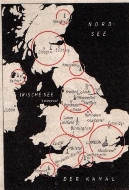
Abb. 3. Gesamtansicht des neuen Fernsehsenders in Sutton Coldfield. Abb. 4 (links) Übersichtskarte über den Ausbau des englischen Fernsehens (bisher sind die Sender London und Sutton Coldfield in Betrieb, der Bau der übrigen ist vorgesehen)
