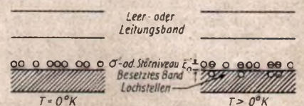
Abb. 4. Energiebandschema und Darstellung des Leitungsmechanismus eines Mangel-Halbleiters (P-Typ)
