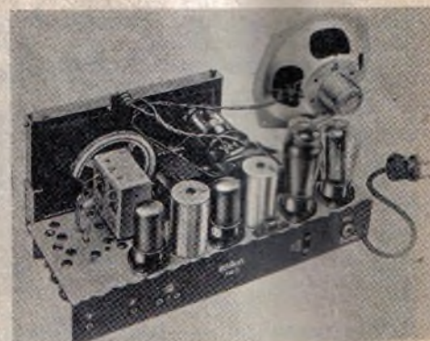
Chassissicht des Wechselstrom-Supers Braun 750 W mit 5 Röhren, 6 Kreisen
