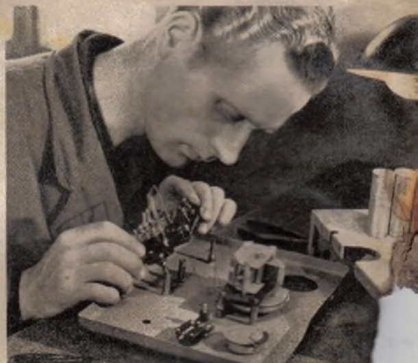
Einsetzen des Spulensatzes mit Spulenschalter auf das Gehäuse des Prüfsenders. Die Spulen sind mit Speziallack gehärtet. Links: Eichen des Prüfsenders. Das Holz ist gestattet Eichungen von 0,1%, die Senderleistung
