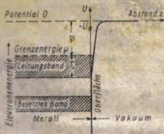
Abb. 1. Energiebandschema eines Metalles mit Darstellung des Randpotentials. \psi ist das Austrittspotential, \epsilon das chemische Potential. Die Grenzenergie \mu wird auch als Fermi-Niveau bezeichnet, d. i. dasjenige Niveau, für das die Wahrscheinlichkeit der Besetzung mit einem Elektron bei gegebener Temperatur den Wert 0,5 hat
