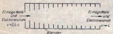
Abb. 1. Linearbeschleuniger mit fortschreitender Beschleunigungswelle
