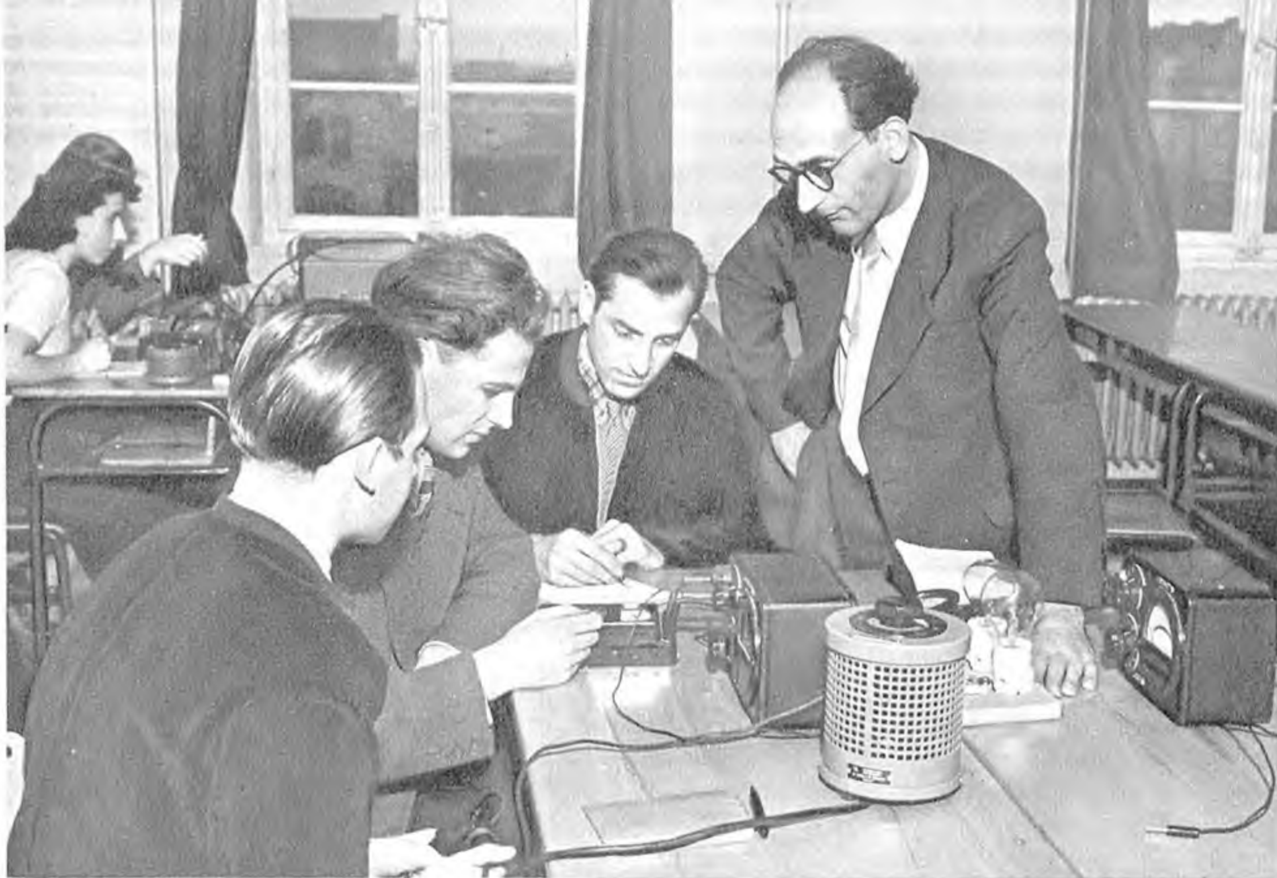
Unter der Anleitung von Dipl.-Ing. Schneider nehmen die Kurssteilnehmer im elektro-physikalischen Praktikum die Widerstandskurve einer Kohlefadenlampe in Abhängigkeit von der Spannung auf
