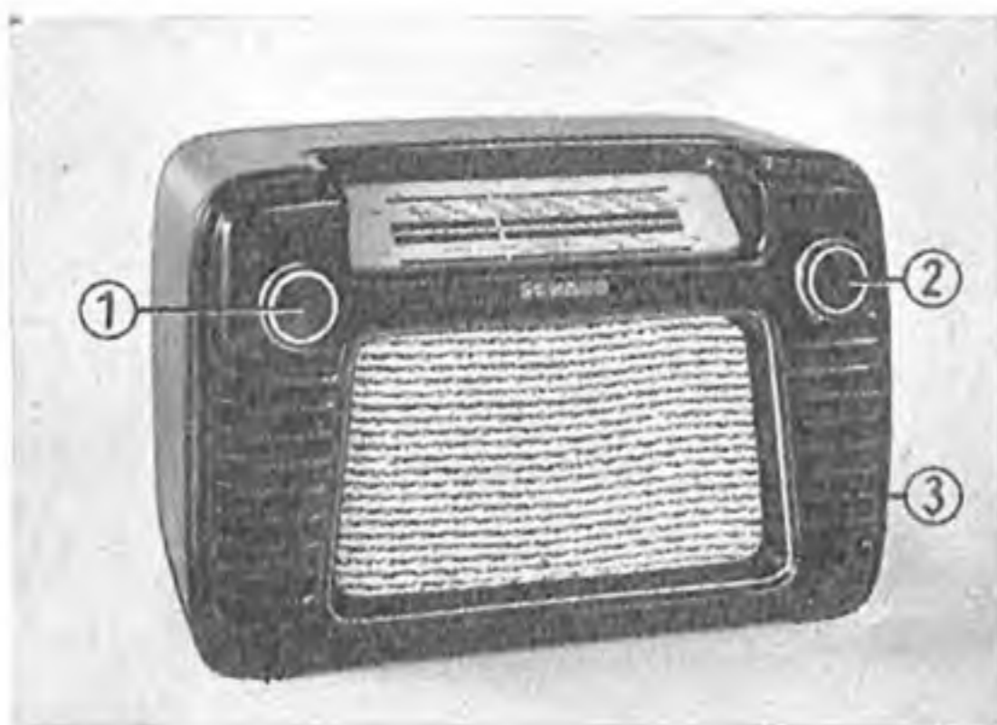
① Lautstärkeregelung mit Netzschalter, ② Abstimmung, ③ (seitlich) Wellenbereichsschalter
