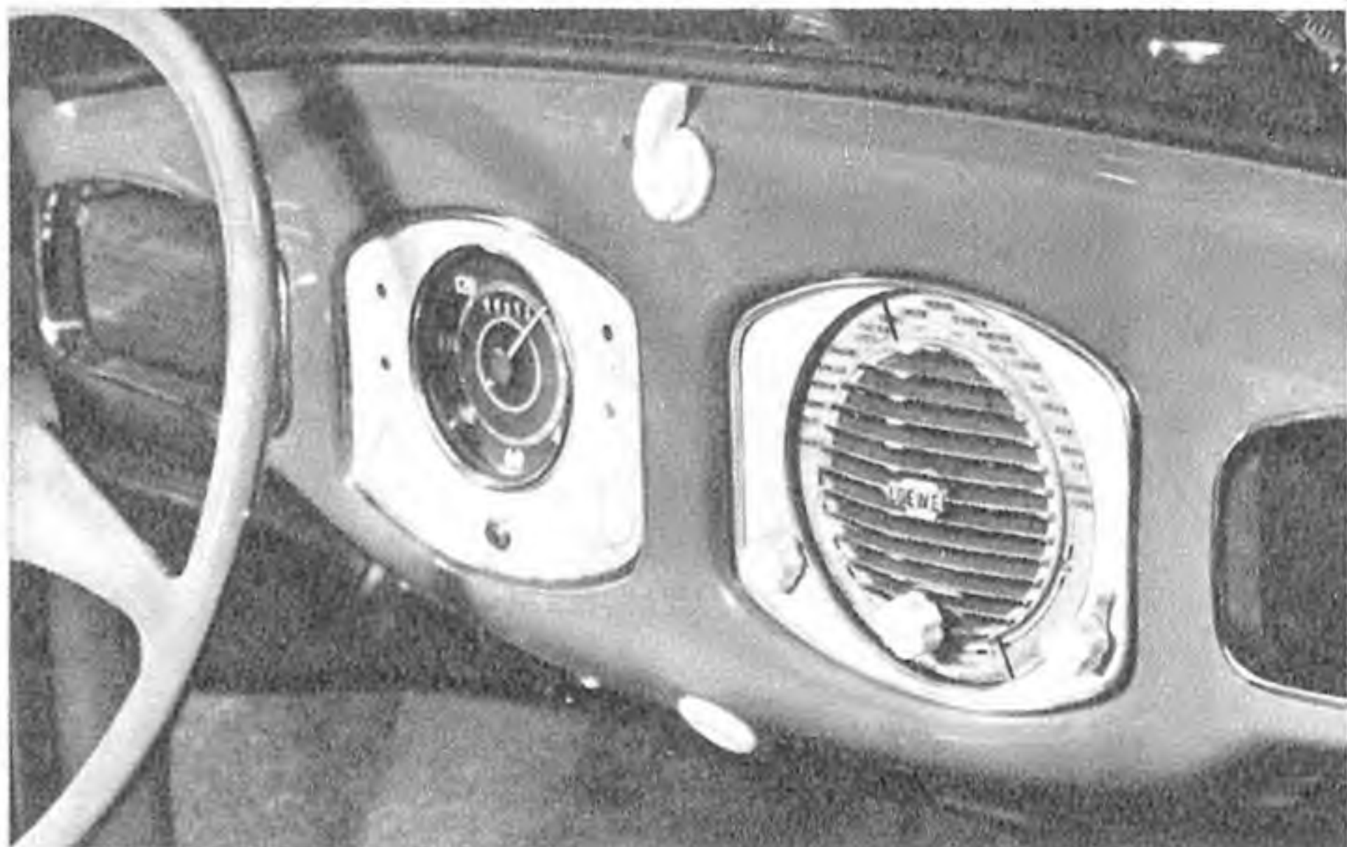
Links das deutsche, oben das amerikanische Gesicht des Autosupers. Der in dem Nash-Wagen eingebaute Empfänger hat nur zwei Bedienungsknöpfe. Die dazwischenliegenden runden Öffnungen dienen für den Tonaustritt
