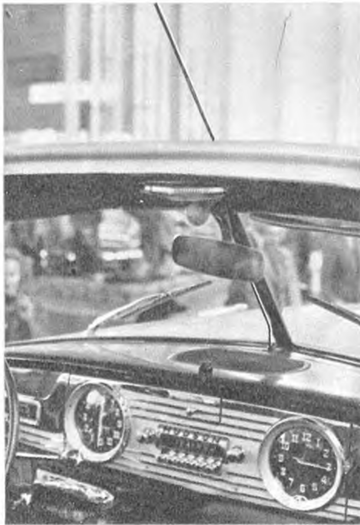
Beim amerikanischen Hudson ist der Autosuper in seinem Äußeren sorgfältig dem Stil des Armaturenbrettes angepaßt. Die Antenne wird auf dem kürzesten Wege hinter dem Mittelpfosten der Windschutzscheibe in den Empfänger eingeführt. Der Lautsprecher im pullartigen Armaturenbrett (Mitte des Bildes) strahlt nach oben
