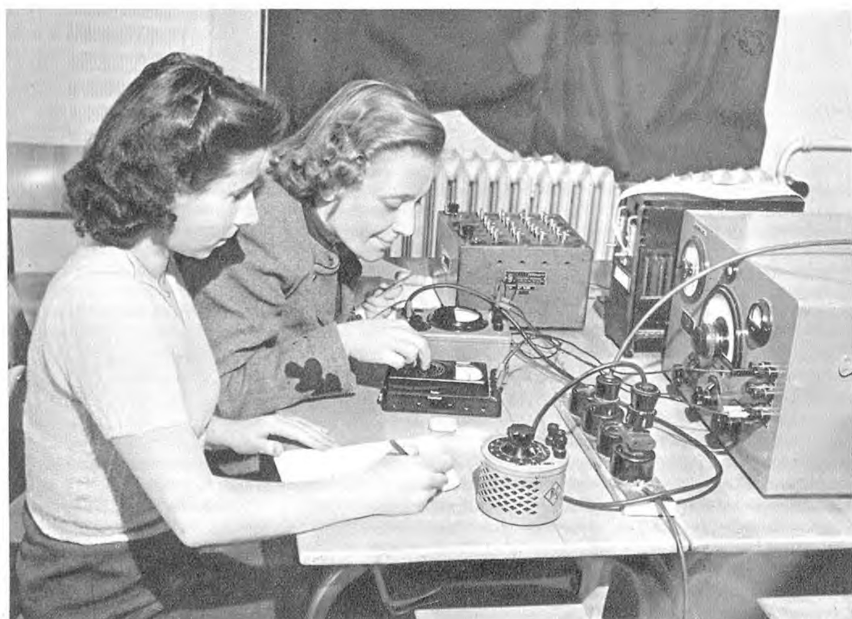
Wichtig ist auch noch die Untersuchung auf die Homogenität ihrer Schicht, die bei etwa 20% der Bänder vorgenommen wird. Diese besonders geprüften Bänder verwendet man in den Funkhäusern für einmalige und besonders kostspielige Aufnahmen
