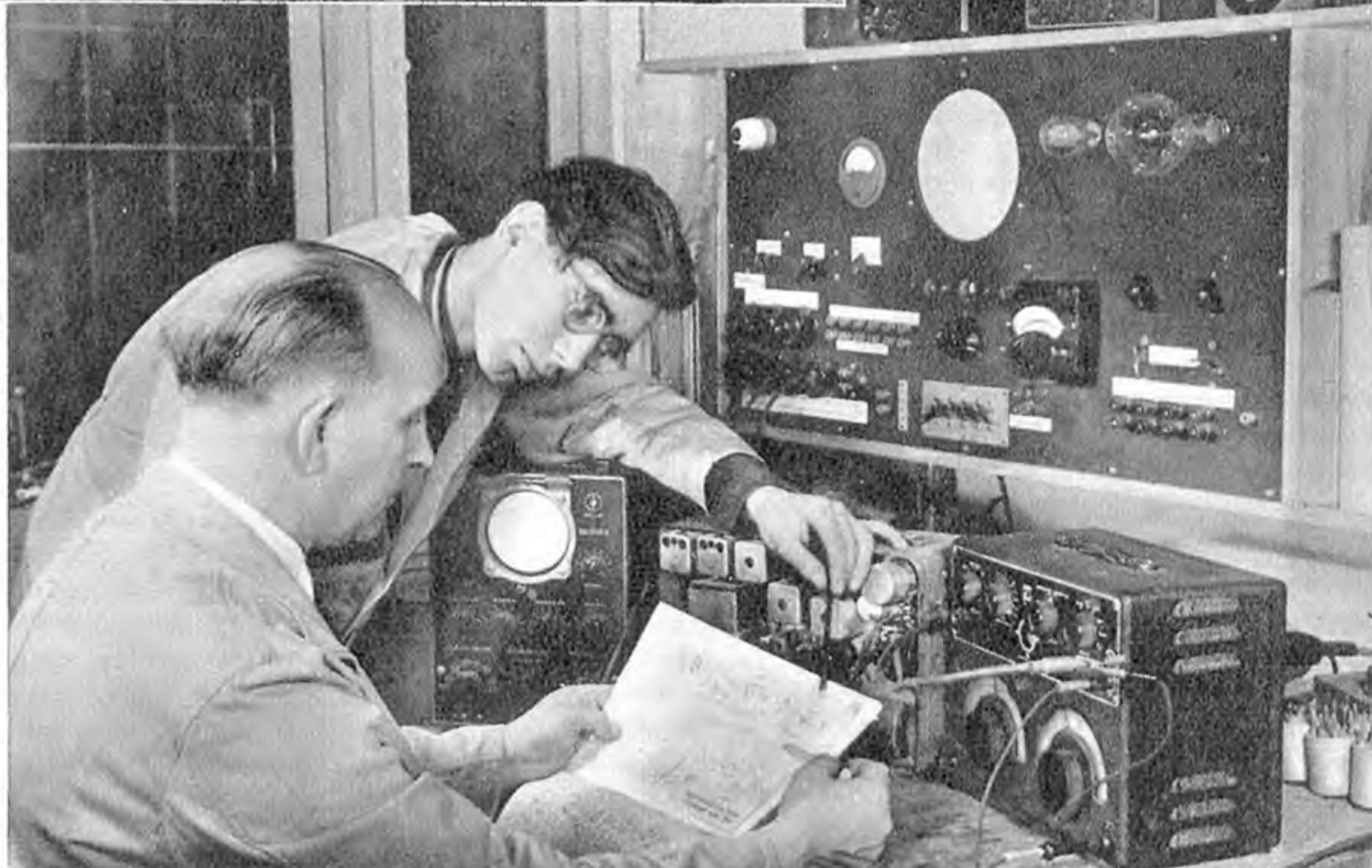
Die Berechnung für das Wickeln eines Trafos ist eine willkommene Gelegenheit, die theoretischen Kenntnisse nachzuprüfen. Links: An Hand von Industrieschaltplänen wird ein Empfänger überprüft
