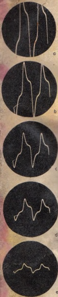
Abb. 5. Wahl der günstigsten Bildhöhe. a) und b) Bildhöhe wird überschritten, c) günstige Einstellung, d) noch brauchbar, e) zu niedrige Höhe läßt zu wenig Einzelheiten erkennen
