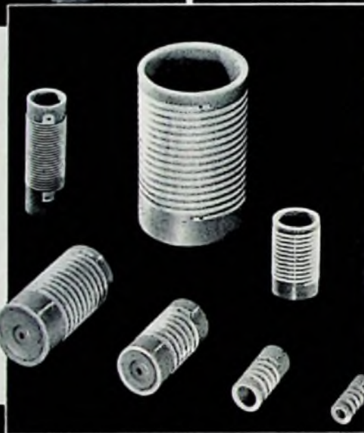
Keramische Spulen aus Elit mit eingebrannten und gal- vanisch verstärkten Silber- windungen für Selbstinduk- tionen von 0,03 bis 100 \mu H. Garantierter Mindest-Güte- faktor und Maximal-Gleich- strom-Widerstand · Tempe- ratur-Koeffizient der Selbst- induktion 10 \cdot 10^{-6}
