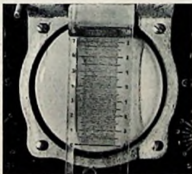
Abb. 11. Verschiebbare Skala für quantitative Messungen mit Elektronenstrahl-Oszillografen
