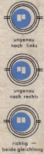
Der Großsuper „Graalszauber“ verwendet eine amerikanische Abstimm- anzeigeröhre mit zwei Systemen (Abstimmungs-Schirmbilder s. rechts)
