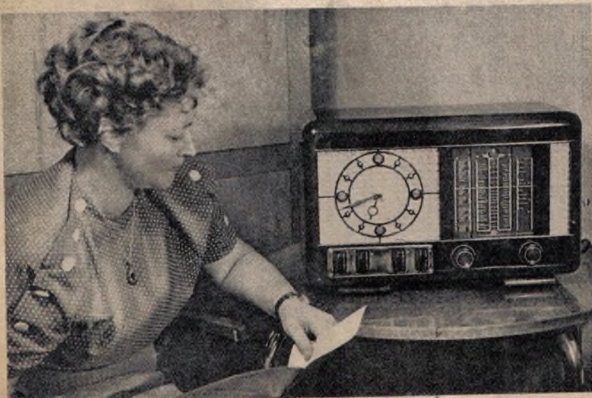
Achtkreis-Super von Lumophon mit Zeitangabe durch 8-Tage-Laufwerk
