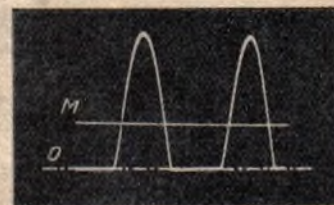
Abb. 19. Beispiel des Oszillogrammes eines pulsierenden Gleichstromes
