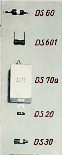
Abb. 8. Form und Abmessung der Germaniumdioden und links, Abb. 9, die Ansicht der einzelnen Dioden
