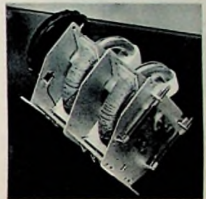
Abb. 14. Versuchsausführung einer Ferrocart-Permeabilitätsabstimmung der Firma Vogt & Co. für den Vor- und Oszillatorkreis eines Superhets
