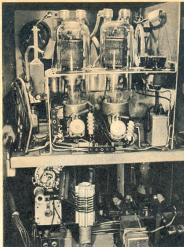
Abb. 6. Blick auf Endstufe (rechts) und Antennenabstimmteil (links)
