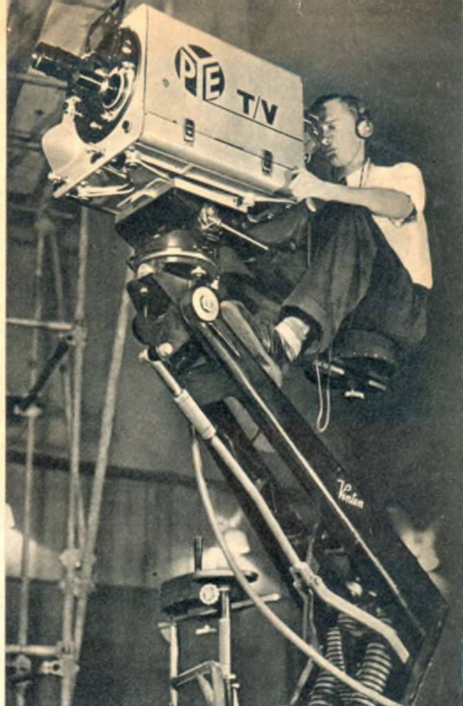
Drei PYE-Aufnahmekameras standen für die Abwicklung des gesamten Programms zur Verfügung. Unser Bild oben zeigt die Aufnahmekamera ohne Schutzhülle. Der Kameramann kann sowohl durch den Bildtubus als auch durch die aufgesetzten Bildeinsteller die Aufnahmen vornehmen. Rechts: Die Kamera läßt sich in jede Lage ausschwenken. Sie besitzt vier Auswechsellinien verschiedener Brennweiten
