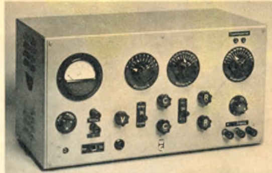
Abb. 2. Außen- und (oben) Chassisansicht des Klirrfaktormessgerätes
