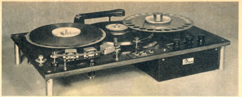
Sich einen Magnetbandspieler mit erschwinglichen Einzelteilen aufzubauen, ist sicherlich der Wunsch vieler Amateure. Die gezeigten Einzelteile werden mit AEG-Lizenz hergestellt. Lösch-, Aufnahme- und Wiedergabeköpfe auf einer Platte sind Duoton-Opto-Erzeugnisse
