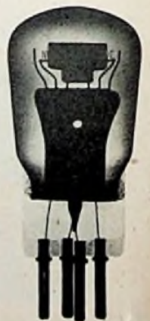
Röntgenaufnahme einer Röhre (Valvo Oekonom)
