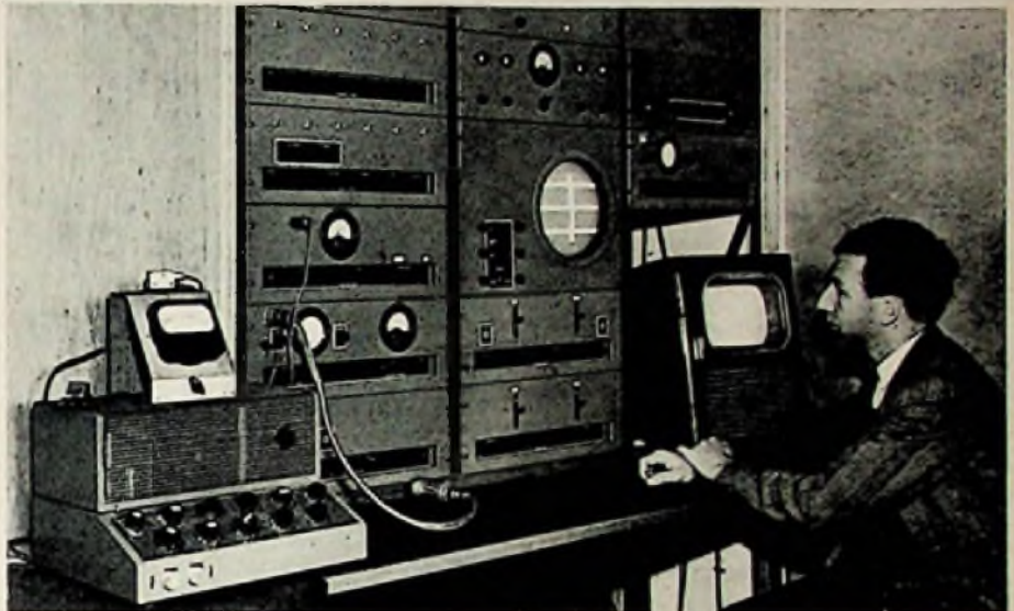
Kontrollgestell des modernen von Philips gelieferten 5-kW-Fernsehenders, der in Kopenhagen aufgestellt ist. Rechts ein Philips-Empfänger zur Überwachung des ausgestrahlten Bildes
