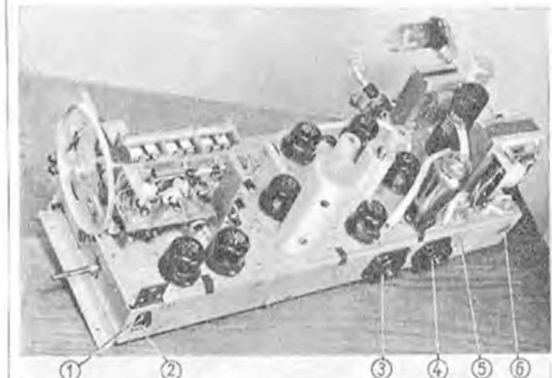
① Antennenanschluß, ② Erdanschluß, ③ Anschluß für Tonabnehmer, ④ Anschluß für zweiten Lautsprecher, ⑤ Dipolanschluß, ⑥ Spannungswähler
