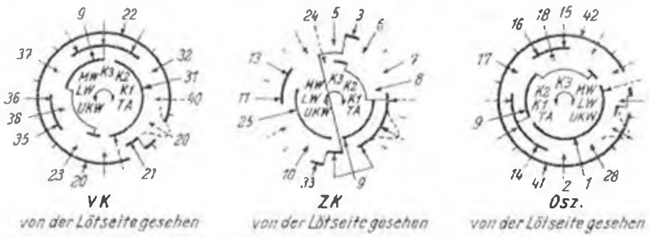
Wellenschalter. Gezeichnete Stellung: MW
