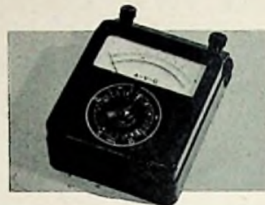
Abb. 2. Mikroampere-Multizet von S & H; kleinster Meßbereich 20 µA, Spannungsbereiche 50000 Ohm/V
