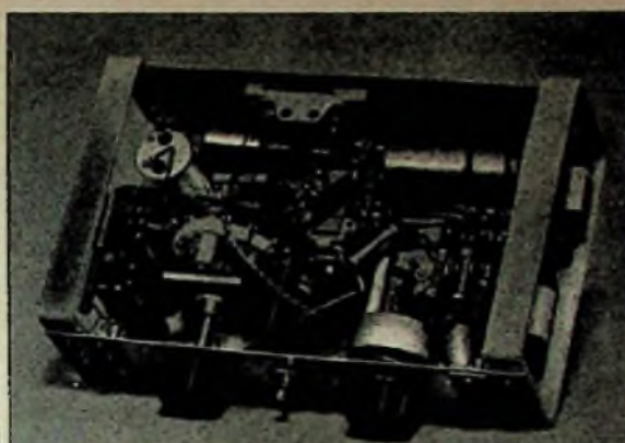
Praktischer Aufbau des kompletten Zweiröhren-Magnettonverstärkers für Allstrombetrieb. Die Verdrahtungsansicht rechts zeigt das ziemlich „gefüllte“ 20×13×6 cm große Alu-Chassis von unten. Man erkennt den unmittelbar an der Fassung der UF 14 angebrachten Vierfach-Umschalter, links davon den Eingangsübertrager mit HF-Drossel
