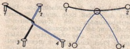
Abb. 1. Ältere Ausführung eines Thermokreuzes Abb. 2. Verbindung des Heizfadens und des Thermoelementes durch eine Glasperle
