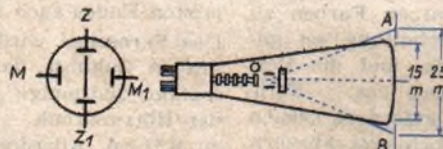
Abb. 2. Zwischen den Zeitplatten Z/Z_1 wird der »Tiefenstrich« geschrieben (siehe Text)
