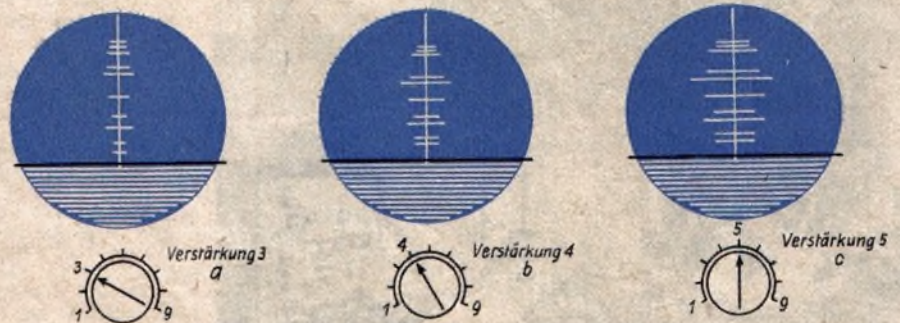
Abb. 7. Der gleiche Fischschwarm ergibt auf dem Schirm je nach Verstärkungsrad des Echos verschiedene Echolängen, so daß die richtige Beurteilung des Schirmbildes Übung erfordert
