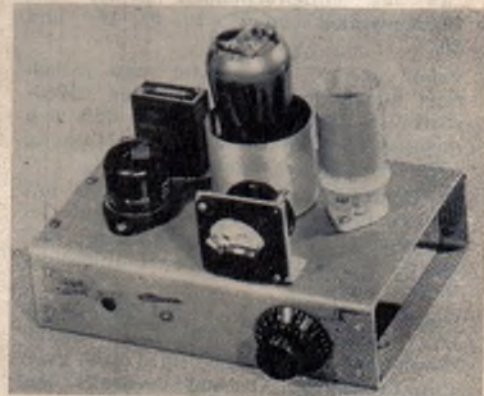
Abb. 4. Experimentieraufbau des zweistufigen Senders nach Abb. 3
