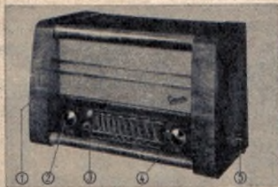
① Klangfarbenregler, ② Drehen: Ein-Aus-Schalter und Lautstärkeregelung, Zug-Druck: Sparschaltung/Normalschaltung, ③ Anzeige der Klangfarbenstellung, ④ Senderabstimmung, ⑤ Wellenbereichschalter
