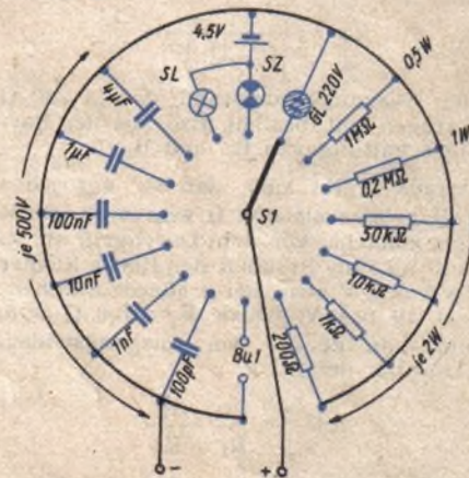
Abb. 1. Schaltung des Reparatur-Schnellprüfgerätes
