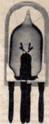
Abb. 4. Röntgenbild eines Thermokreuzes
