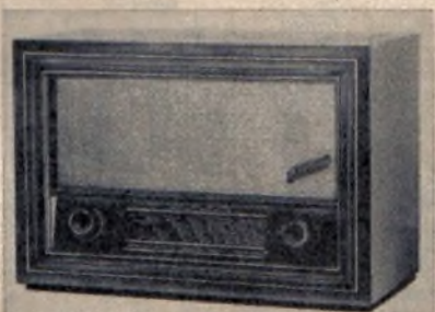
Links: Lautstärkereglern mit Netzschalter, ferner Klangfarbenregler. Rechts: Senderabstimmung, außerdem Wellenbereichschalter
