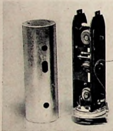
Regelbares ZF-Bandfilter Abb. 1. Ansicht des im Superhet ver- wendeten regel- baren Bandfilters
