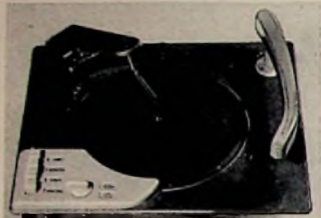
Ein schwedischer Plattenwechsler der Firma AGA für große und kleine Platten, auch für Gemischteinlegung, mit mannigfaltiger Schallmöglichkeit
