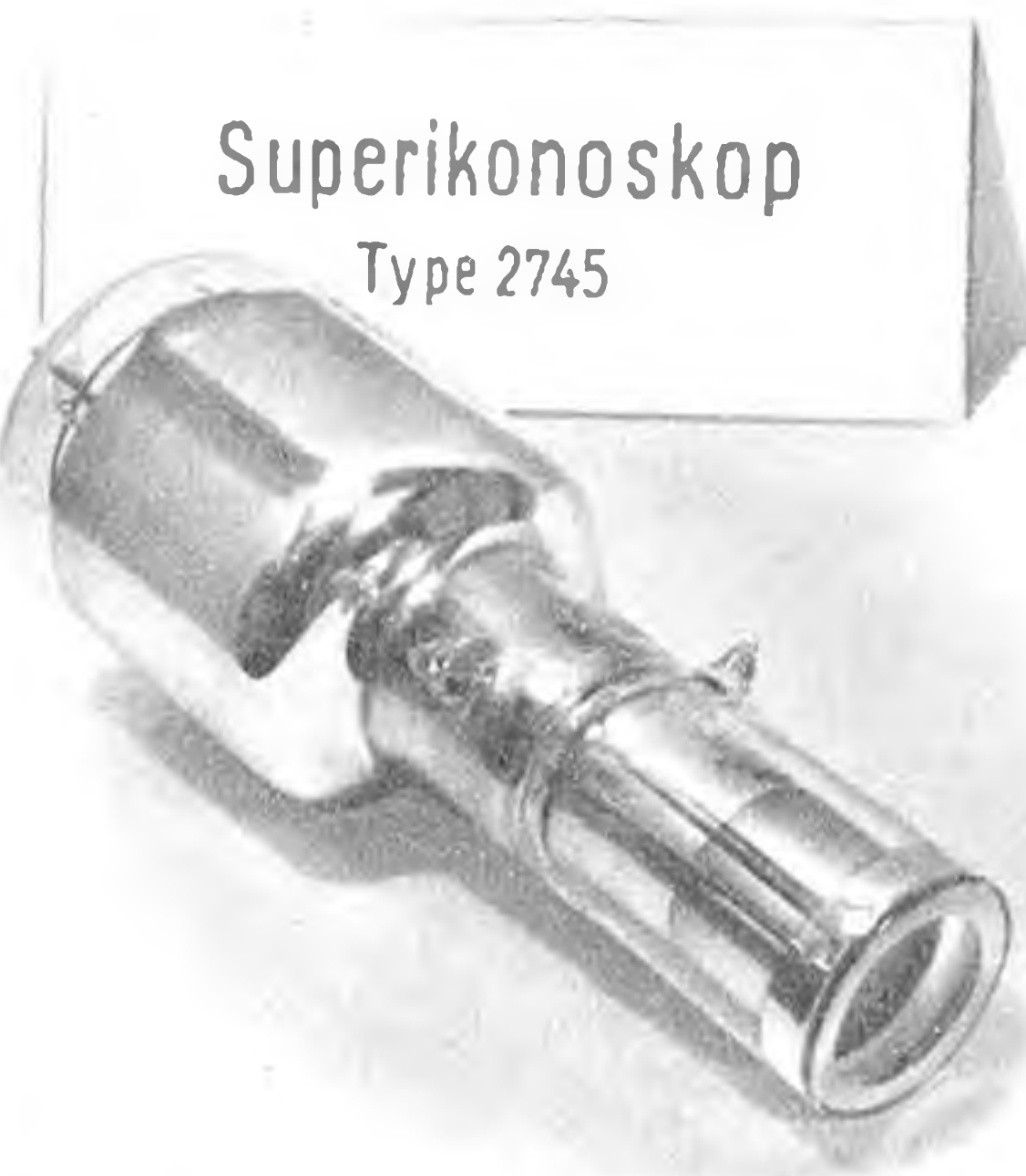
Superikonoskop für Fernsehkameras und links Netzvervielfacher mit elektronenoptischer Abbildung der Fotokathode, zwei Entwicklungen des Fernmeldewerkes „HF“
