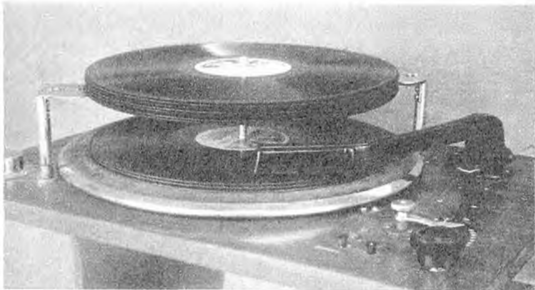
Abb. 1. Der selbstgebaute Wechsler beim Abspielen der dritten Platte; Bedienungsfeld rechte vordere Ecke
