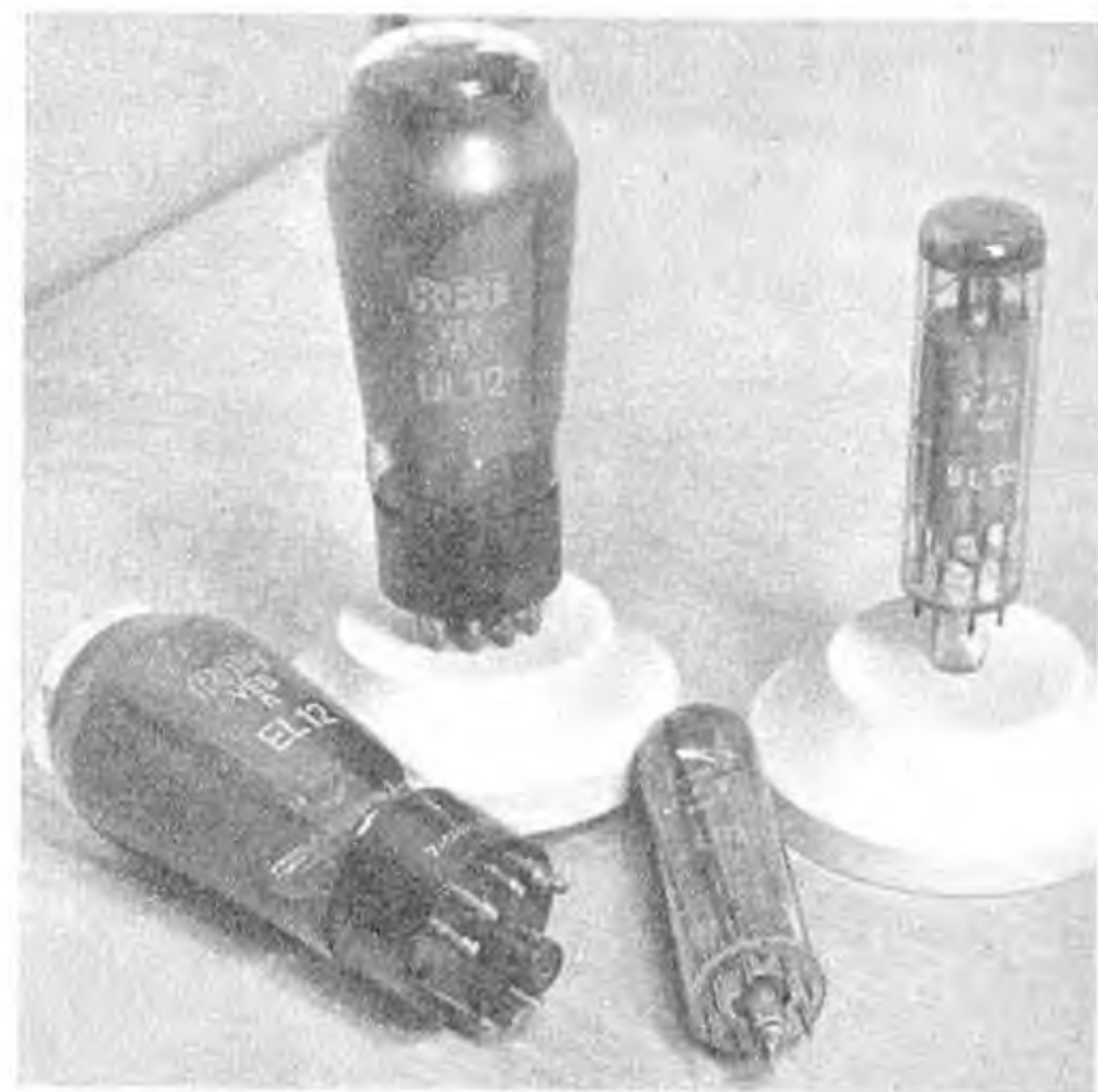
Zwei Röhren der Gnom-Serie im Vergleich mit alten Glasröhren
