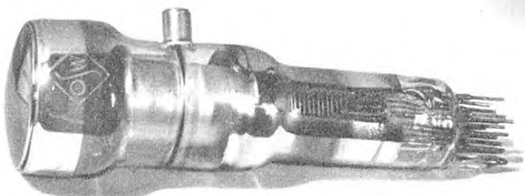
Superikonoskop für Fernsehkameras und links Netzvervielfacher mit elektronenoptischer Abbildung der Fotokathode, zwei Entwicklungen des Fernmeldewerkes „HF“
