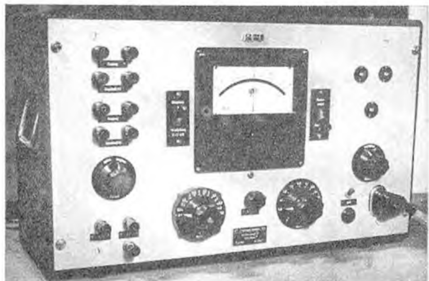
Vierpolmeßgerät Typ VPM 1 zur Dämpfungs- und Verstärkungsmessung
