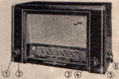
Vorderansicht: (1) Netzschalter mit Lautstärkeregler; (2) Bandbreitenregler mit Klangblende; (3) Wellenbereichsanzeige; (4) Senderabstimmung (Schwungrad); (5) KW-Lupe und UKW-Abstimmung; (6) Wellenbereichschalter
