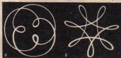
Abb. 7. Bilder mit dem Frequenzverhältnis \frac{5}{2} a) Epizykloide b) Hypozykloide
