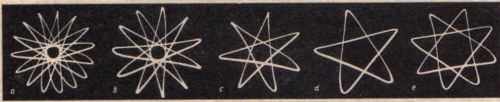
Abb. 9. Hypozyklidenbilder mit geraden Seiten bei ungeradzahigen Frequenzverhältnissen
