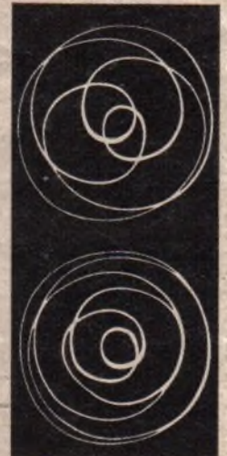
Abb. 7. Bilder mit dem Frequenzverhältnis \frac{5}{2} a) Epizykloide b) Hypozykloide
