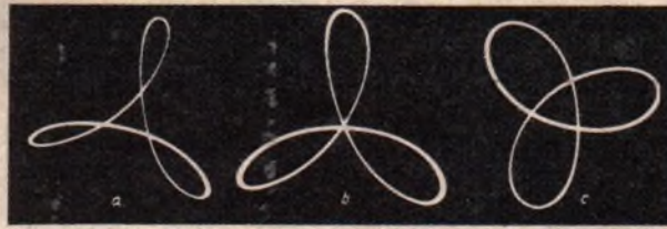
Abb. 6. Einfluß der Amplitude der Vergleichsspannungen auf das Bild der Hypozykloide
