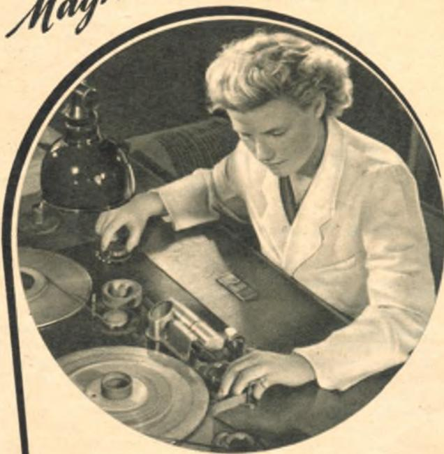
Auf die Sorgfalt, mit der das Magnetophonband BASF geprüft wird, kommt es an. — Sicherer Blick, Fingerspitzengefühl und eine automatisch arbeitende Fotozelleneinrichtung, die auf kleinste Fehler genauestens reagiert, sind zuverlässige Bürgen für die hohe Fehlerfreiheit und große Gleichmäßigkeit der Typen L extra und LGH.
