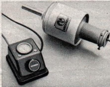
Kathrein-Antennen-Rotor; links Bedienungskästchen, rechts Antennenfuß mit eingebaut. Motor
