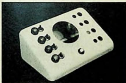
Elfenbeinfarbiges Hauptstellen-Gehäuse für Wechselsprechanlagen mit Lodungen für Kleinlautsprecher, Signallampen und Leitungswähler
