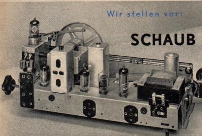
Abb. 1. Chassis des Schaub „KORALLE“ (links UKW-Eingangsstufe mit ECH 42 und zwei Zwischenfrequenz-Sperrkreisen für 10,7 MHz)
