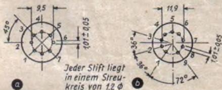
Abb. 3. Anordnung der Sockelstifte von Miniaturröhren mit 7 bzw. 9 Stiften
