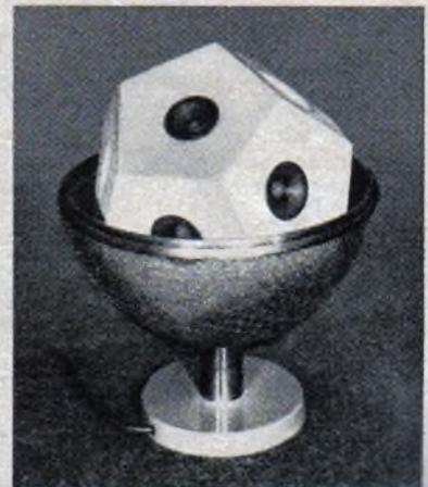
Abb. 4. Hochtonkugel des NWDR mit zwölf kleinen Chassis (obere Hälfte der Schutzhülle ist entfernt)
