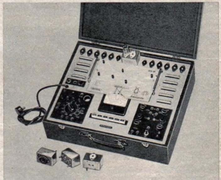
Hilfe des Meßempfängers sofort feststellen, ob Fehler an Reparaturgeräten auf eine fehlerhafte Fernsehempfangs- oder auf das Gerät selbst zurückzuführen sind. Eine besondere Buchse liefert das Video-Signal für allerlei Prüfzwecke.
