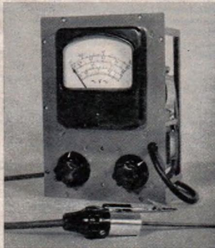
Abb. 4. Röhrenvoltmeter mit Tastkopf gemäß Schaltung Abb. 5
