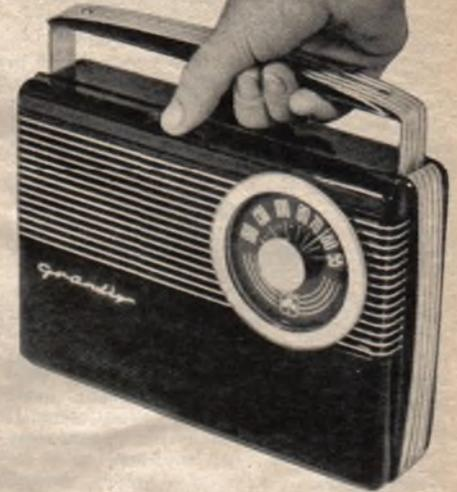
AM, 8 auf FM, 6 Röhren (ECH 42, 2 x EF 41, EBC 41, EL 41) plus Netzgleichrichter, zweifache FM-Zwischenfrequenzverstärkung und Ratio-Detektor als Abschluß des FM-Zweiges. Die Bandbreite im AM-ZF-Teil kann zweistufig geregelt werden, während die Tonblende dreistufig ausgeführt ist. Für den UKW-Empfang ist die bewährte „Netzantenne“ vorgesehen. Das Preßstoffgehäuse ist mit 53 x 33 x 22 cm relativ groß. Nicht vorhanden, um es nicht zu verschweigen, ist eine HF-Vorstufe auf UKW.
