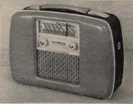
Unsere Abbildung zeigt dieses Modell, dem die beiden übrigen Typen weitgehend ähneln. Das massive Holzgehäuse ist mit Kunstleder bezogen bzw. — siehe oben — auf Wunsch mit echtem Leder verkleidet und besitzt eine Buchse zum Anschluß einer Kraftwagenantenne. Sobald sie eingesteckt wird, schaltet sich die eingebaute Rahmenantenne ab.
