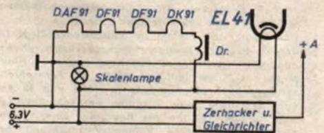
Abb. 2 Vereinfachtes Schaltbild bei Betrieb des Kofferempfängers aus der Starterbatterie 6,3 V
