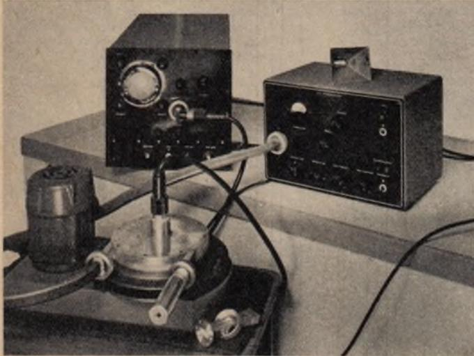
UKW - Meßplatz von Rohde & Schwarz, rechts außen Impedanzmesser mit einer Anzeigscheibe aus Maltglas mit mehreren auswechselbaren Diagrammen
