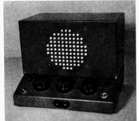
Abb. 10. Getrenntes Mischgerät mit Kontroll-Lautsprecher
