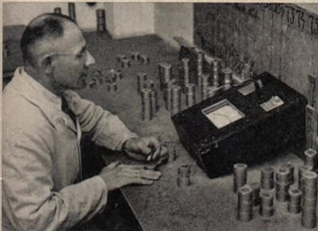
Abb. 6. Selengleichrichter-Prüfgerät
