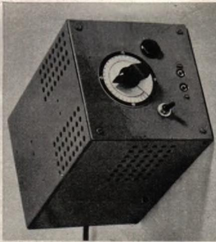
Rechteckgenerator. Bestückung EL 41 und AZ 41. Die Abmessungen des eisernen Einbaukastens sind: 15x15x23 cm
