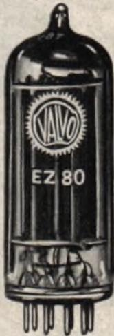
Die Valvo EZ 80 ist als Zweiweg-Gleichrichter für Rundfunk-Geräte entwickelt und mit Noval-Sockel ausgeführt. Ihr Katodenstrom von 90 mA reicht auch zur Speisung größerer AM FM-Empfänger aus. Die Abbildung 1 zeigt die Strom-Spannungskennlinie einer Gleichrichterstrecke, aus der man den besonders niedrigen Innenwiderstand ablesen kann.
