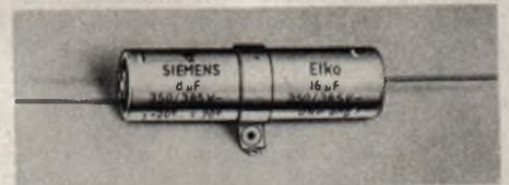
Abb. 8. Freitragender Hochvolt-Elektrolyt-Kondensator in zylindrischem Aluminiumgehäuse mit Mittelschelle und mit axialen Anschlußdrähten
