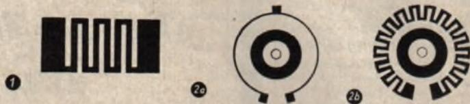
Abb. 1. Form eines nicht veränderbaren Metallfilm-Widerstandes. Abb. 2. Zwei Ausführungen von Metallfilm-Widerstandsbahnen für Drehpotentiometer
