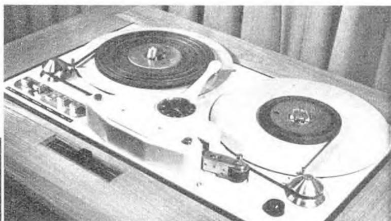
**Hochleistungs-Magnetongerät „BG 83-11“** für Rundfunkstudios, Tonfilmateliers usw. Bandgeschwindigkeit 38,1 cm/s; Laufzeit 40 min für 1000 m Band; Frequenzbereich von 40 bis 10 000 Hz; Klirrfaktor bei 1000 Hz  $\leq 3\%$ . Funkwerk Köpenick
