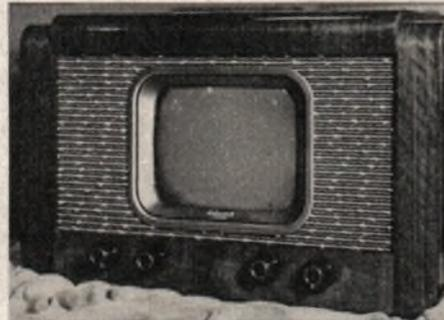
„FE 852“ Fernseh- und Rundfunkempfänger für 3 Fernsehkanäle (49,75; 59,25; 77,25 MHz) Bild und Ton, 66 ... 67,5 MHz UKW, mit statischer Ablenkung und mit einer magnetischen Fokussierung
