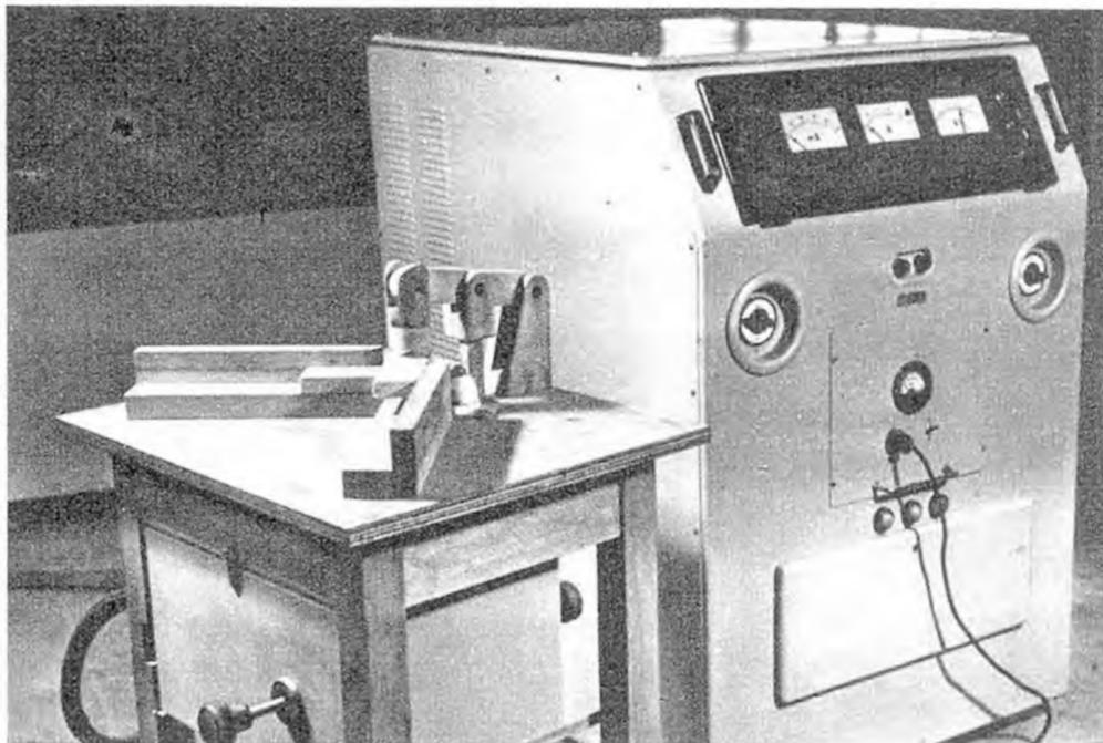
2-kW-HF-Generator (Ausführung B) mit einer Arbeitsfrequenz von  $27,12 \text{ MHz} \pm 0,6 \%$  zur Furnier-, Schicht- und Sperrholzverleimung im Holzbau. Funkwerk Köpenick
