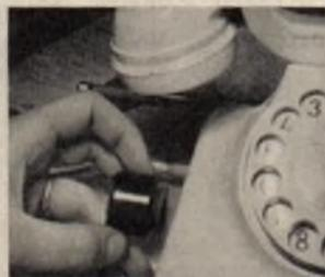
Eine kleine Spule, in der vom Fernsprechapparat tonfrequente Spannungen induziert werden, ist in einem kleinen Gehäuse untergebracht. In recht einfacher Weise wird mit Hilfe eines Gummisaug-
