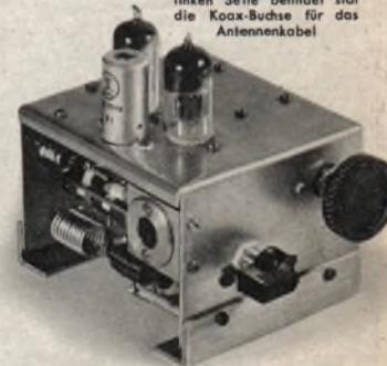
Es versteht sich von selbst, daß die Zwischenkreistrimmung um so leichter ist, je höher die ZF liegt, je größer also der Abstand zwischen Oszillator- und Empfangsfrequenz ist. Zur Erleichterung der Trimmerarbeiten kann man evtl. kurzzeitig den Summer eines alten Läutewerkes im Nachbarraum schnarren lassen und (damit die Funkenstörungen gut hörbar sind) an die Kontaktfeder oder -schraube einen Draht anklammern, der etwa halb so lang ist wie die Wellenlänge des gerade abzugleichenden Bandes.
