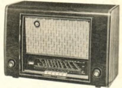
8 Kreise und bei FM 9 Kreise. Außer der guten Empfindlichkeit (UKW = 1  $\mu$ V, K = 6  $\mu$ V, M = 5  $\mu$ V, L = 12  $\mu$ V) ist besonders auch dem NF-Teil große Aufmerksamkeit geschenkt worden. Zwei EL 41 in Gegentakt sichern dem Gerät eine Sprechleistung von 10 W. Neben dem Orchester-Lautpre-
