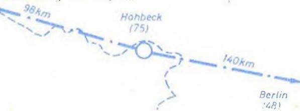
Die Turmhöhe ist bei den einzelnen Relaisstationen verschieden. In der norddeutschen Ebene — bei den Relaisstationen Egestorf und Wardböhlen, wo nur geringe natürliche Höhen zur Verfügung stehen, ist sie bis zur obersten Plattform 70 m, bei den übrigen schwankt sie je nach den Erfordernissen zwischen 25 und 40 m.
