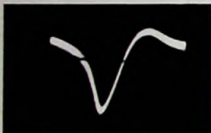
Abb. 9. Diskriminator-Kurve bei schwachen Signalen. Rauschen an jenen Stellen sichtbar, bei denen die Begrenzung nicht wirksam ist
