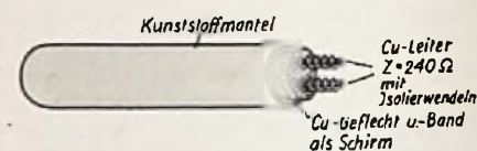
Abb. 23. Symmetrische Rundkabel mit Wellenwiderstand Z = 240 Ohm
