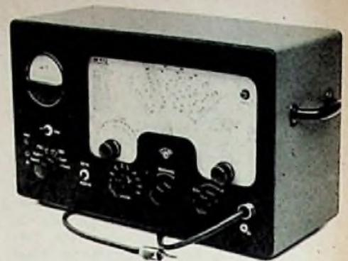
Abb. 12. Außenansicht des UKW-Fernseh-Meßsenders „M 612“
